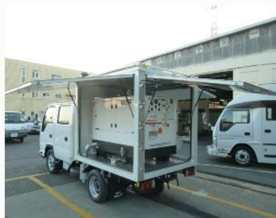
電源車 Power supply car
